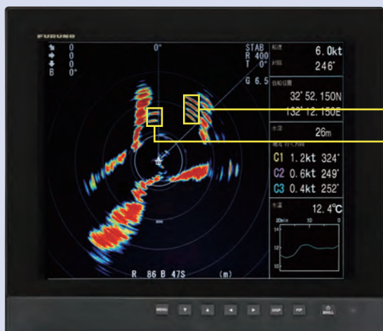
CSH-8L MARK-2で捉えた水中の橋脚の反応(黄色の枠内)
